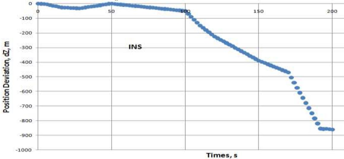
Fig. 8. Estimation error Z coordinate
